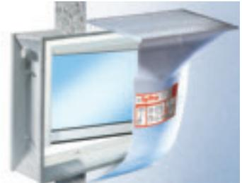
Einbau eines Kellerfensters mit Leibung und Kellerlichtschacht im Schnitt. (SyPro)
