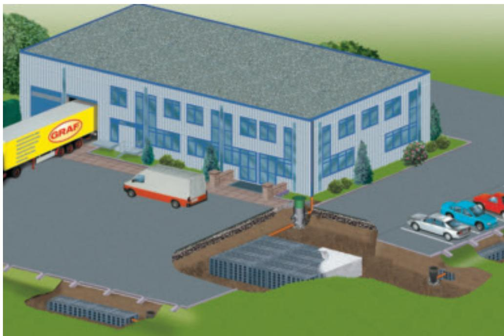
Der Graf Sicker-Bloc ist mit 5 t pro m<sup>2</sup> LKW-befahrbar - der Nutzung der darüber liegenden Oberfläche sind somit keine Grenzen gesetzt. (Graf)
