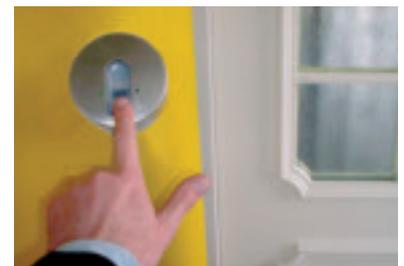
Der Finger ist der Schlüssel – Fingerprint-Sensor. (TRYBA)
