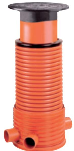
**Kanal-Schacht IC 630 mit Schachtkörper, Steigrohr, Dichtmanschette und Teleskopabdeckung. (PIPELIFE)**
