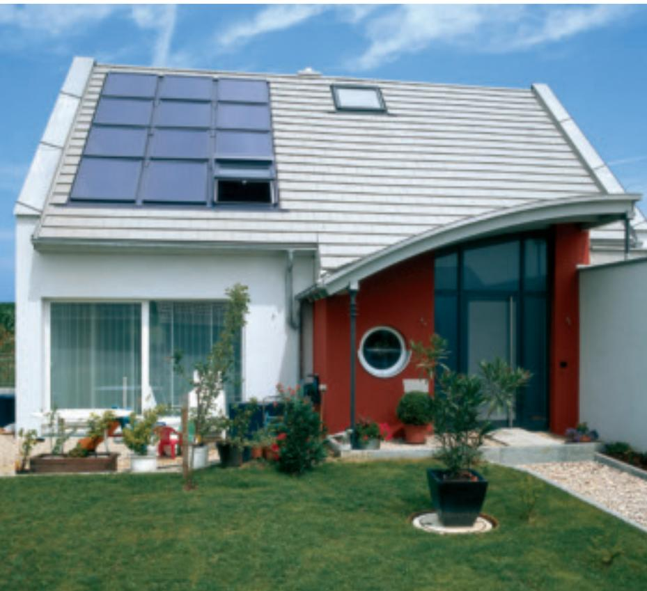
Solarkollektoren decken den Energiebedarf für Warmwasser und zum Teil für die Heizung. (VELUX)
